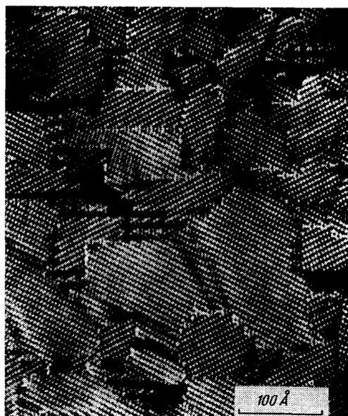
Рис. 44. «Ковер» из доменов в сплаве Au<sub>5</sub>Mn<sub>2</sub> после отжига<sup>105</sup>.
